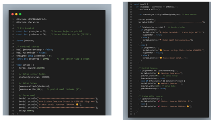
Gambar 2. Tampilan Kode Program Sistem Smart Clothesline untuk ESP8266
